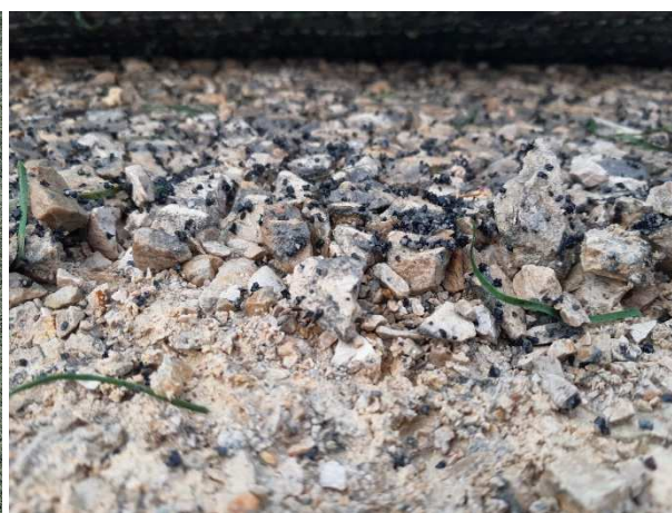
Sondage S2 : surface de la fondation ouverte : apparition des fines à environ 1,5 cm de la surface.
