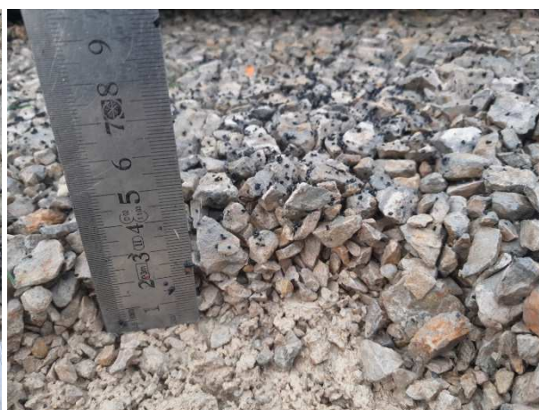
Sondage S3 : Vue sur la surface de la fondation – apparition des fines à environ 3,5 cm.
