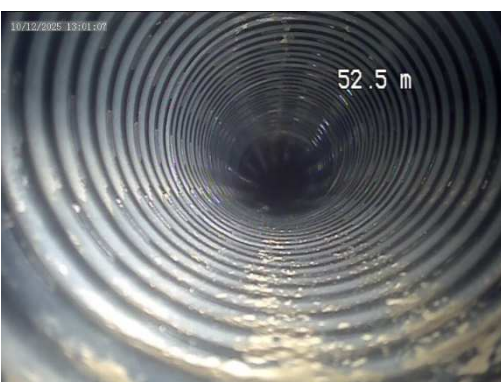
Drain 8 – Quelques retenues d'eau et dépôt de fines.
