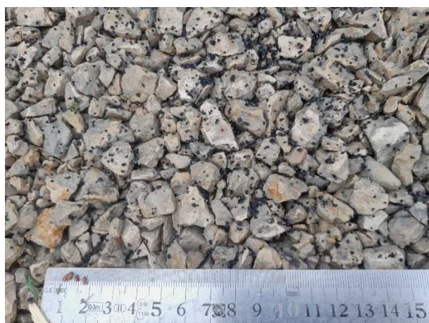
Sondage S3 : Vue sur la surface de la fondation – apparition des fines à environ 3,5 cm.
