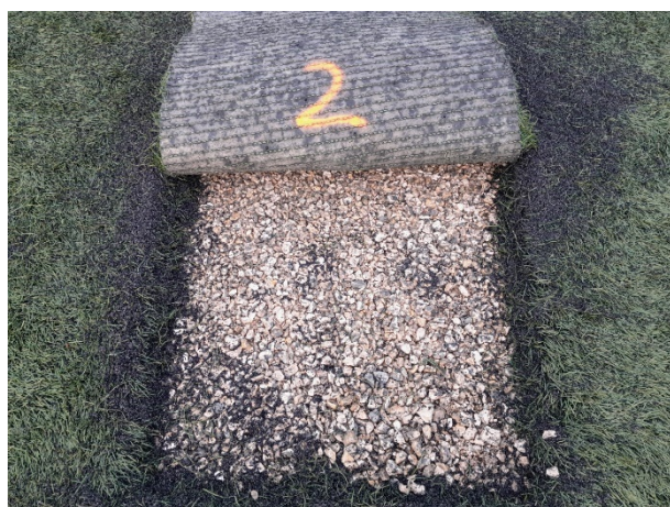
Sondage S2 : surface de la fondation ouverte : apparition des fines à environ 1,5 cm de la surface.
