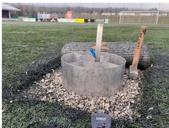
Perméamètre double-anneau, in situ.
