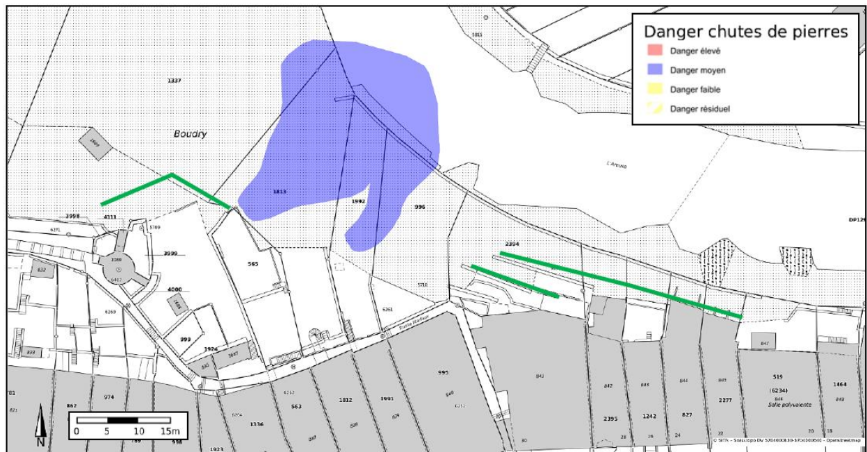
Figure 4 : Extrait de la carte de danger de chutes de pierres et blocs au niveau des secteurs à sécuriser. En vert : position des ouvrages de sécurisation à réaliser
