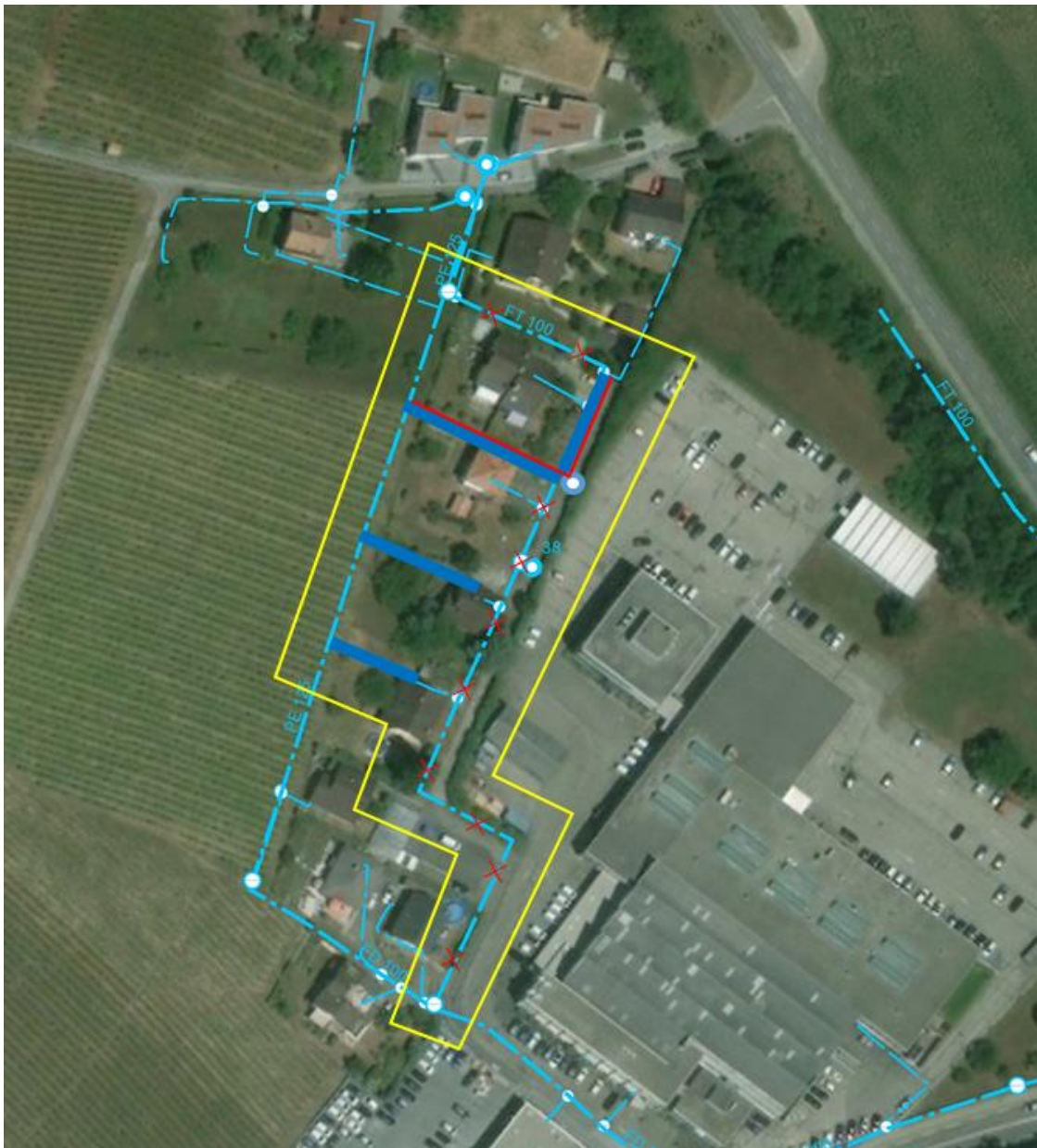
L'image ci-dessus représente la zone des travaux et les nouveaux tronçons EAU/ELEC
